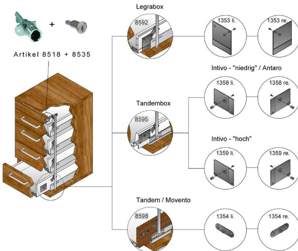
Linke Sperrplatte dient als Distanzplatte und verhindert ungewolltes Öffnen.
